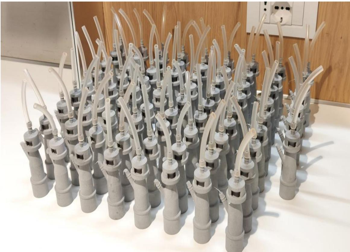
Importante destacar que as válvulas feitas na impressora 3D não visam substituir permanentemente as peças originais, que são mais
